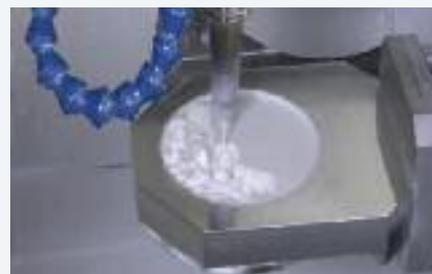
Fig. 27 Fase iniziale di formatura di ponti e corone in zirconia. Si osservi la solida ghiera in acciaio che trattiene stabilmente la cialda di materiale ceramico crudo durante l'alesatura.
