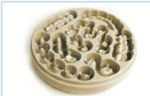
Fig. 23 Schema di posizionamento di corone e ponti all'interno di una cialda da fresatura in modo da ottimizzare gli spazi e ridurre gli sprechi di materiale.
