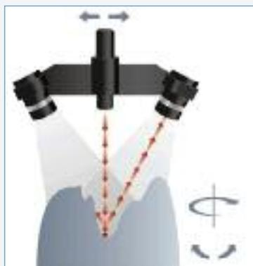
Fig. 8 Scanner 3Shape Mod D700. Uno dei più avanzati sistemi di digitalizzazione con sistema di rilevazione ottico-topometrico.
