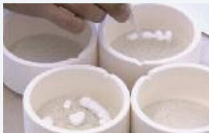
Fig. 29 Preparazione delle strutture di corone e ponti alla fase di sinterizzazione.
