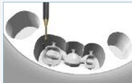
Fig. 6 Lavorazione automatizzata di un ponte in zirconia.
