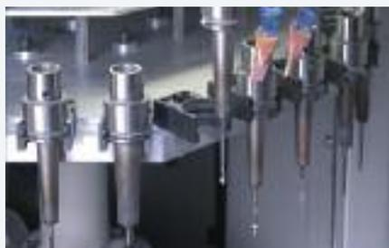
Fig. 26 Faretra del fresatore industriale Cara System® Heraeus. Gli utensili rotanti di calibro diverso vengono automaticamente selezionati e sostituiti in relazione alla fase di alesatura dei pezzi.
