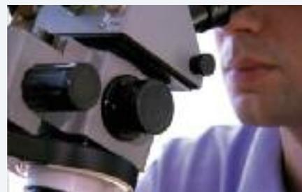
Fig. 30 Verifica di qualità dei pezzi allo stereomicroscopio dopo la sinterizzazione.
