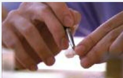
Fig. 28 Accurata pulizia di un ponte in zirconia dopo la fresatura.
